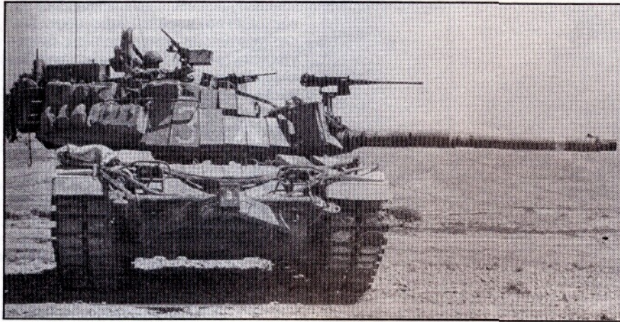
■ M60A1 «Магач», оснащенный элементами динамической защиты
