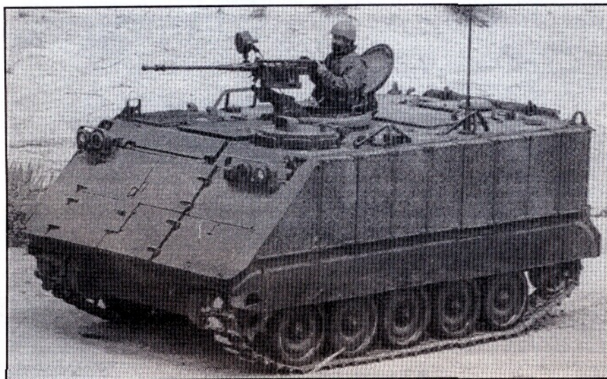
■ Израильский бронетранспортер М113 с дополнительной бронезащитой
