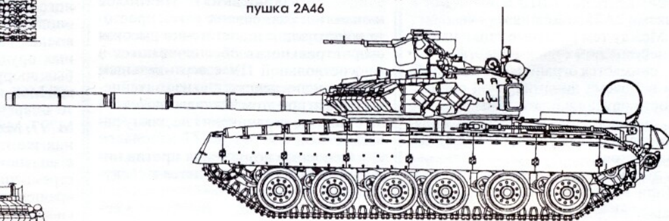
■ Т-72. Основное вооружение — 125-мм гладкоствольная пушка 2А46
