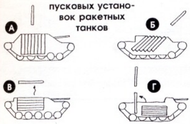
А — вертикальный старт; Б — наклонный старт; В — горизонтальный выброс; Г — поворот перед пуском
